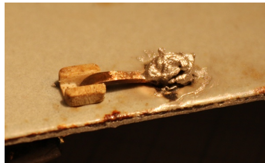
Bild 3: links defekter Anschluss mit Kleberresten, rechts mit leitfähigem Epoxykleber reparierter Anschluss.
